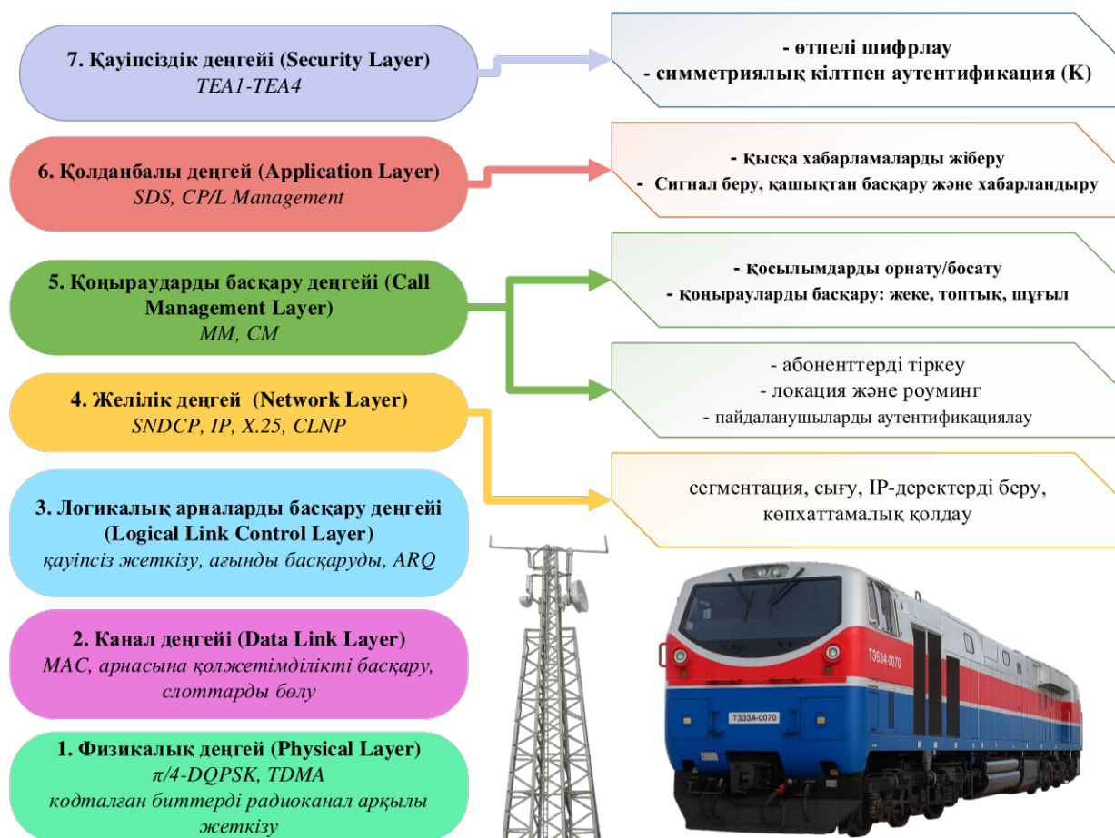
Сурет 3.3 – TETRA стандартының протоколдарындағы функциялар
